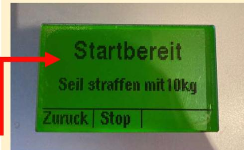
Mit dem Fahrhebel erfolgt beim Kommando „Fertig“ der Start
